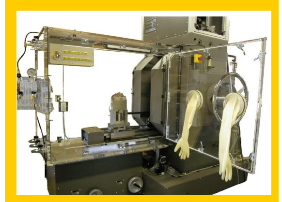
《参考写真》 グローブボックス内部 金型ダイセット移動機構
