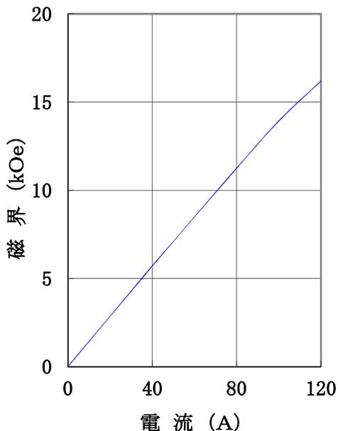
型式 : 45° 傾斜扁平Wヨーク型
