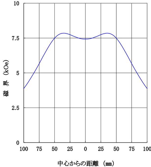
磁極直径 100mm φ (中心75mm φ 孔)
